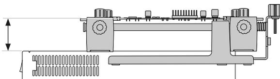
固定用金具を使って、サポートを中段と高段に配置します。
