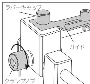
ガイドとラバーキャップをセットする。クランプノブを再度セットし、調整する。
