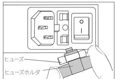
切れたヒューズを取り出し、新しいヒューズをヒューズホルダに押し込みます。最後にクリップでヒューズホルダを元の位置に戻します。
