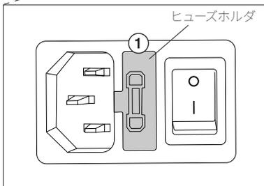
ヒューズホルダを引き抜きます。必要であれば、工具を使用してヒューズホルダを取り外します。
