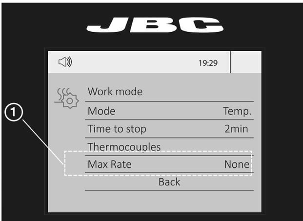
温度モードで作業することで、加熱率の最大値 (Max Rate) を定義することができます。(1)
