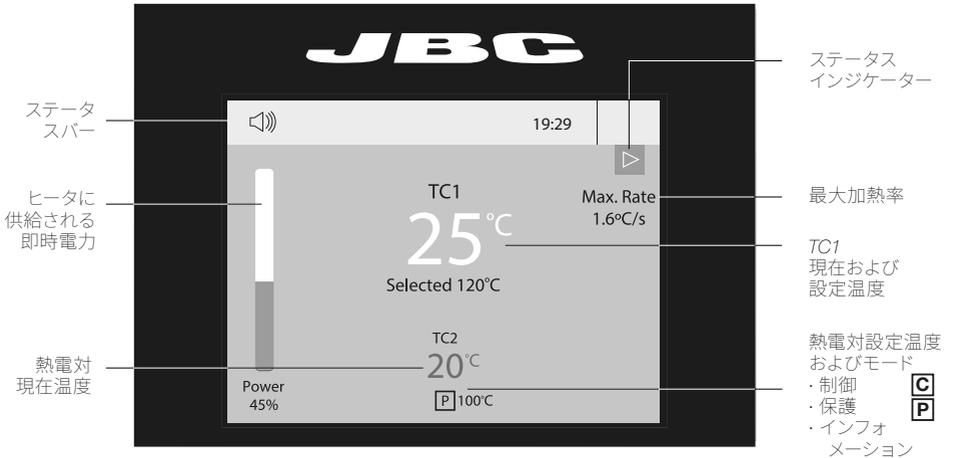
温度モードでの作業では、最大昇温速度値（最大速度）を定義することができます (1)。
