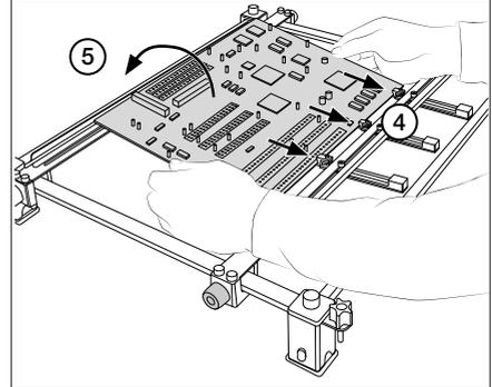
新しいPCBを前面のスライディングガイドのバネ付きクランプにはめ込み、PCBを手前に押して(4)、リアスライディングガイド(5)のクランプにPCBの裏面をはめ込むのに十分なスペースを確保します。
