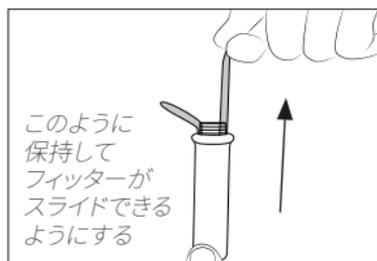
フィッターを取り外すには、グリップを保持してフィッターを引き出します。必要な場合はプライヤーを使用します。
