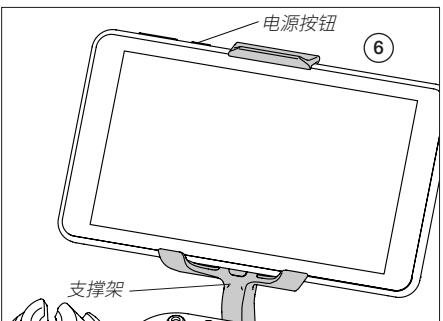
将显示器放在支撑架上，按钮朝上。调整显示器支架的高度，然后拧紧固定旋钮。
