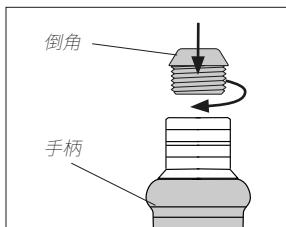
将有倒角的一侧朝上，然后将新的防污内塞拧入手柄衬套，直至拧不动为止。
