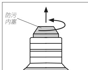
用手拧下磨损的防污内塞将其取下。
