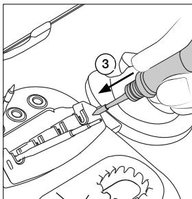
轻轻地将焊嘴压入烙铁头更换座(3)侧面的取装孔中，确保烙铁头正确插入。
