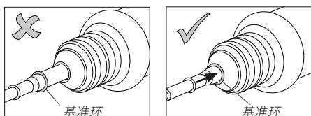
由于 C115 烙铁头的直径比 C210 烙铁头小，因此必须使用转接头才能将它们存放在烙铁头支架中。
