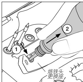
将装有烙铁头的工具放在烙铁头更换座的凹槽上，然后向下按压(1)，直至听到咔嗒声。向外拉动手柄(2)可取下烙铁头。
