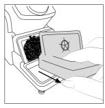
将刮锡垫拉出以拆下。
