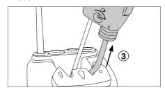
将烙铁头插入焊嘴快换座取装槽中,并向外拉动工具,以取下烙铁头(3)。
