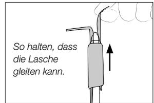
Zum Entfernen der Einsetzhilfen Griff halten und Einsetzhilfen herausziehen. Ggf. eine Zange zum Herausziehen verwenden.
