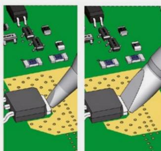
焊嘴的接触面越大, 积累的热能越多, 降温越小。
