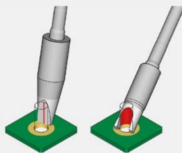
焊嘴与元器件的接触面越大, 导热效果越好。
