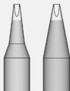
较宽的焊嘴可更快地将热量传递到焊点, 提升焊接效率与品质; 而较细的焊嘴更适合操作难以触及的区域。
