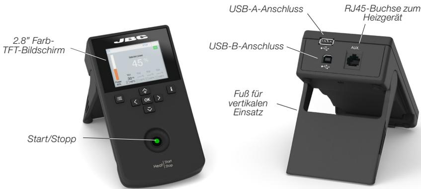
Einfache Überwachung des Prozesses mithilfe des Thermoelements (Typ K).
