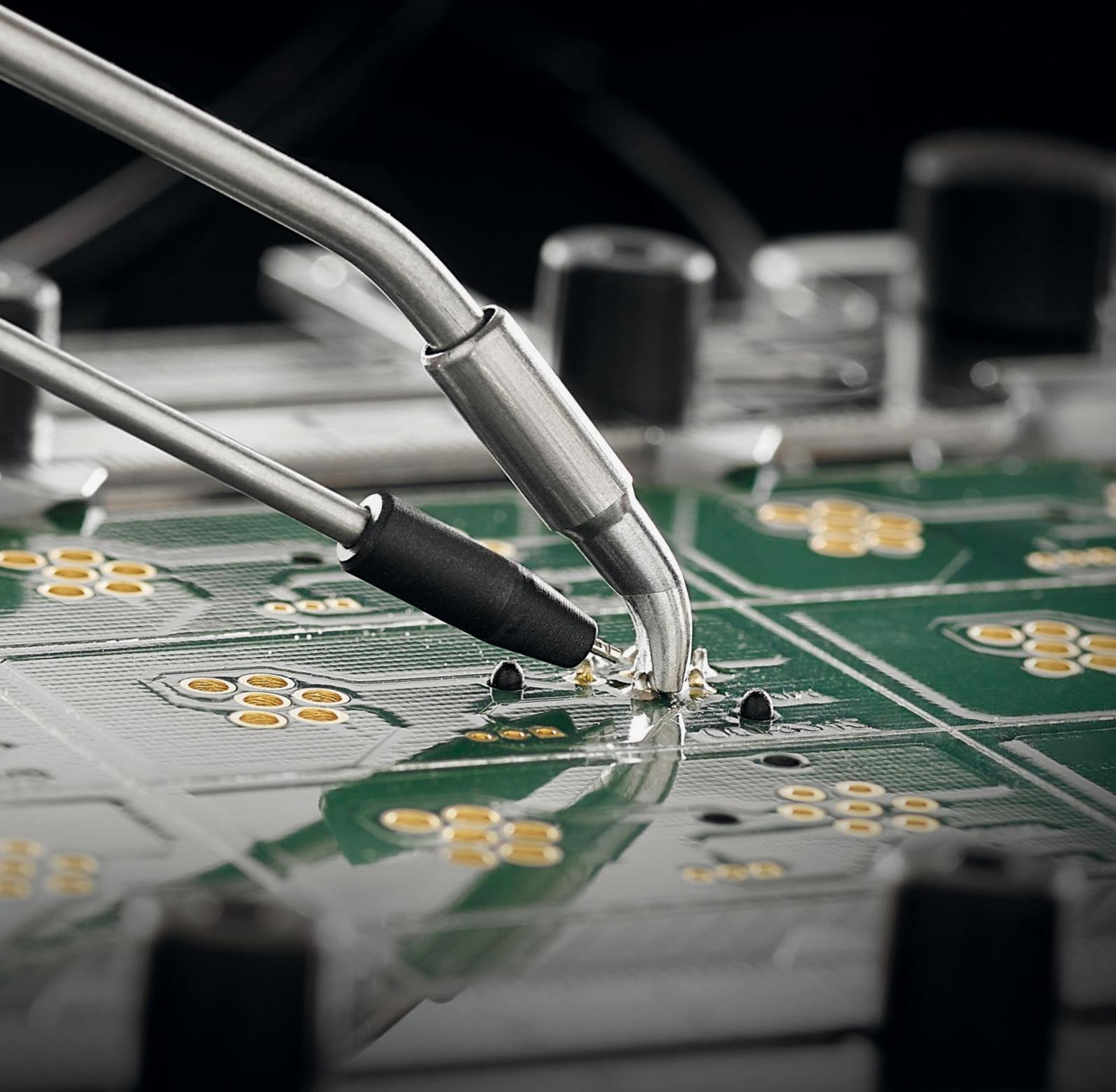
**LötKolben mit automatischer Zuführung**
