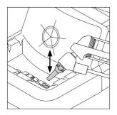
Picchiettare delicatamente per rimuovere la saldatura in eccesso.
