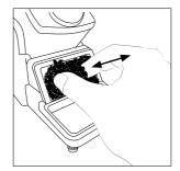
Sostituire la lana d'ottone con una nuova quando è usurata. Rimettere a posto il raschietto o eventualmente sostituirlo.
