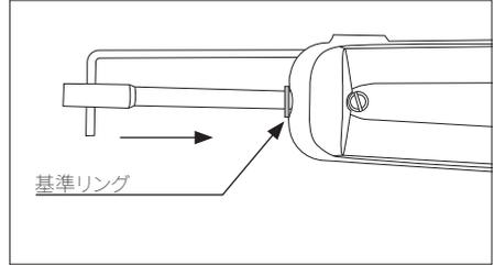
基準リングがワイヤーストリッパーに触れるまでカートリッジを挿入します。リングを基準にして、両方のこて先が一致することを確認します。
