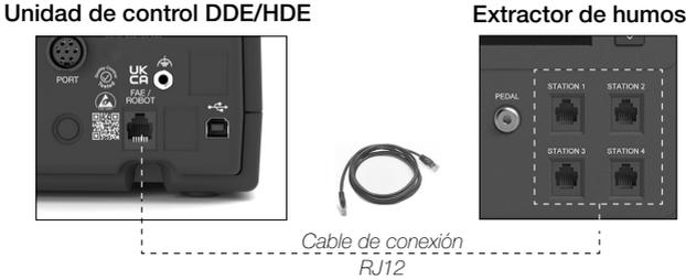
A partir de la versión del software 8886887 para DDE/HDE, el extractor de humos se puede configurar y controlar desde el menú "Peripherals" (1) de la unidad de control.
