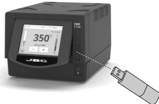
Wenn die Lötstation den USB-Stick nicht erkennt, verwenden Sie bitte eine Software zur Partitionierung des Sticks.
