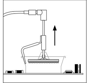
Le composant s'élève automatiquement lorsque la soudure fond.
