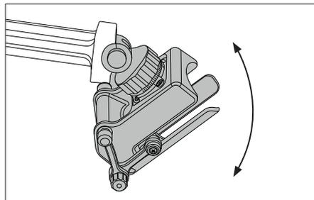
可在  $-40^{\circ}$  到  $+40^{\circ}$  范围内旋转移动。
