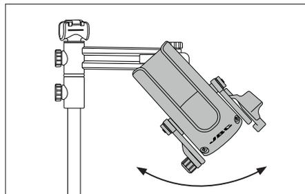
可在  $-90^{\circ}$  到  $+90^{\circ}$  范围内旋转移动。
