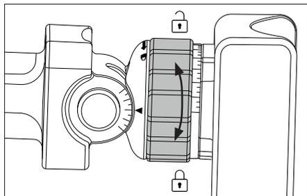
将固定轮转动  $1/4$  圈即可锁定或解锁横向旋转机构。
