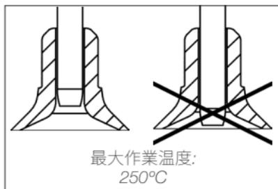
正しく吸引するために、左図のようにニードルをカップに挿入します。
