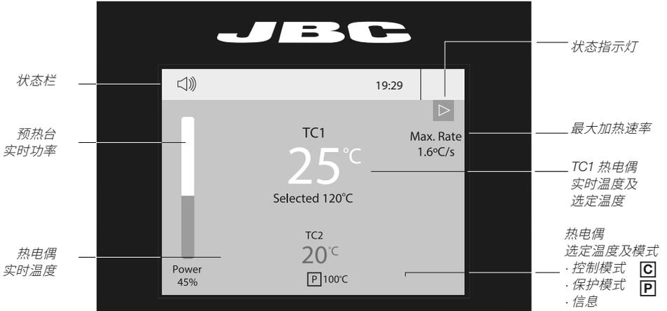
在温度模式下工作，可以定义最大加热速率值 (Max Rate) (1)。
