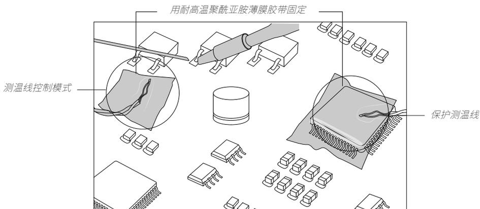
3. JBC 建议升温速率不要超过每秒 3 - 4 °C 建议设定温度，以降低 PCB 上的热冲击风险。
