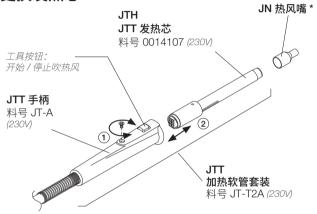
注意: 只有在发热芯冷却且主机断开电源时才可进行此操作。
