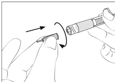
1. キャップをプランジャーハウジング内のニードルと交換します。
