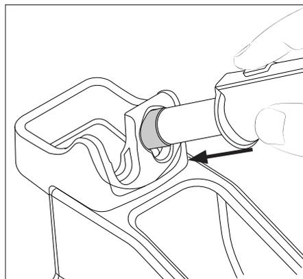
ノズルを取り付け、ノズル交換機構の開口部を利用して、ノズルをヒーターに押し付けます。
