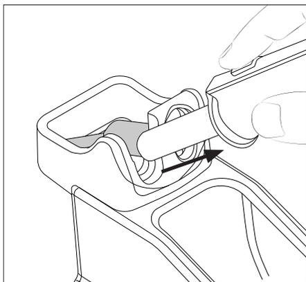
ノズル交換機構にノズルを組み付けたヒーターを入れ、ツールを引いてノズルを取り外します。
