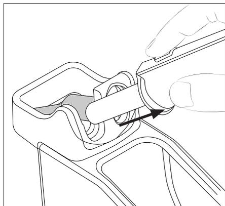
将带有组装好热风嘴的发热芯放置于热风嘴更换座，并向外拉动工具，以取下热风嘴。不用的热风嘴可以放在储放盘中。
