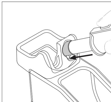
借助更换座的开口装上热风嘴并将其按压到加热芯上。
