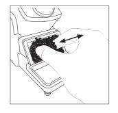
黄铜丝清洁球破损时,请更换 新的。将刮锡垫放回原位,如 有需要,可进行更换。
