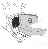
将刮锡垫拉出以拆下。
