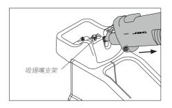
将装有吸锡嘴的手柄放入取装凹槽中,并向外拉动工具,以取下焊嘴。
