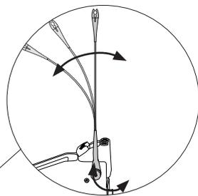
ケーブルコレクタは柔軟に動きます。はんだ付け作業中の動きに追従し、適応します。
