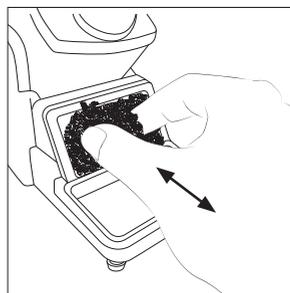
真鍮タワシが消耗したら新しいものと交換します。必要に応じてワイパーを元に戻すか、交換します。
