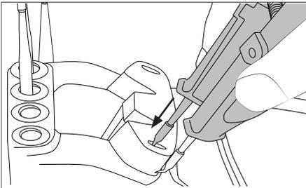
溝を利用して、マーク\*を目印にカートリッジを挿入します。
