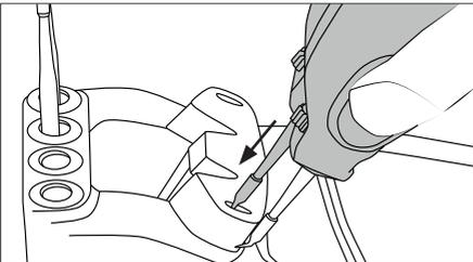
溝を利用して、マーク\*を目印にカートリッジを挿入します。
