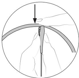
ケーブルをケーブルコレクタクリップに取り付けます。ケーブルは、作業場所に自由に届くよう、必要以上に長くしないでください。
