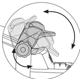
作業位置に合わせてツールホルダーの角度を調節します。
