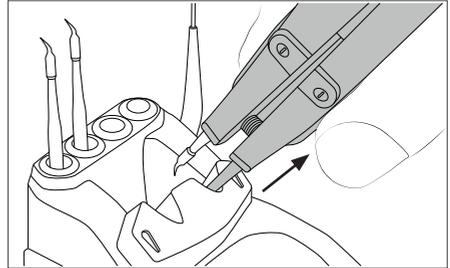
カートリッジをシステムにセットし、ピンセットを引いて取り外します。
