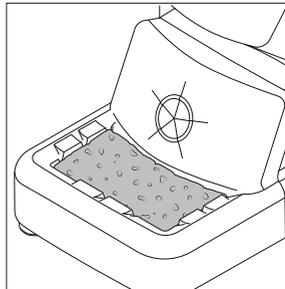
最も優しいクリーニング方法です。こて先の摩耗を防ぐため、作業中はスポンジを蒸留水で湿らせておきます。
