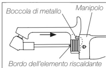
Con il nuovo elemento riscaldante in posizione, serrare la vite di fissaggio, assemblare il gruppo di raccolta dei residui di saldatura e avvitare la punta.
