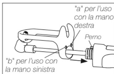
**!** Assicurarsi che l'elemento riscaldante sia inserito fino in fondo. Per garantire un collegamento corretto, la boccola metallica del manipolo deve essere allineata con il bordo dell'elemento riscaldante.
