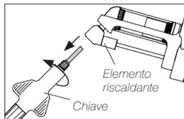
Prendere l'utensile e allentare la vite di fissaggio, estrarre l'elemento riscaldante dall'utensile e sostituirlo con quello nuovo.
