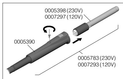
3. Coloque la nueva resistencia, presionando sobre su extremo.
