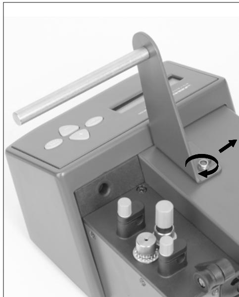
Setzen Sie die Drahtaspelmuffen und die Spule ein (Höchstgewicht 1 kg). Ziehen Sie die 2 Schrauben fest.
