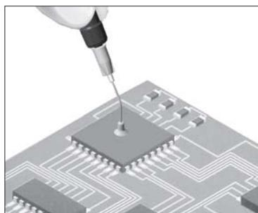
3 Placez le composant dans la bonne position et soudez les pattes. S'il s'agit d'un circuit intégré type «Flat Pack», soudez tout d'abord une patte de chaque angle du CI afin de le fixer au circuit.
