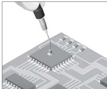
3 Una vez colocado el componente en su posición correcta, suelde las patas. Si se trata de un circuito integrado tipo "Flat Pack", suelde primero una pata de cada ángulo del CI para fijarlo al circuito.
