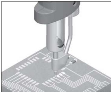
2 Positionner le composant ou le circuit intégré à l'aide du crayon Pick & Place **T260-A**.
