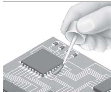
5 Souder les pattes qui restent. Pour cela, nous vous recommandons d'utiliser nos fer à souder JBC qui disposent de 2 modèles de fer à souder:
