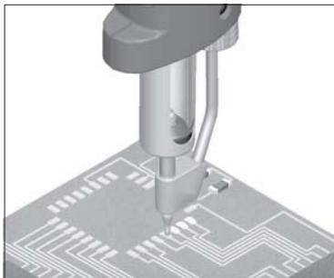
2 Posicionar el componente o circuito integrado con el Pick & Place **T260-A**.
