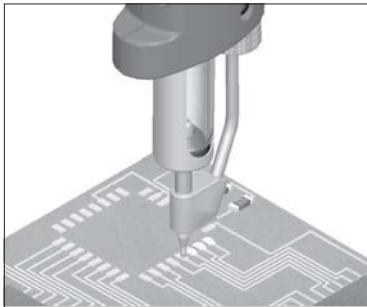
2 Posizionare e centrare il componente o circuito integrato con il Pick & Place **T260-A**
