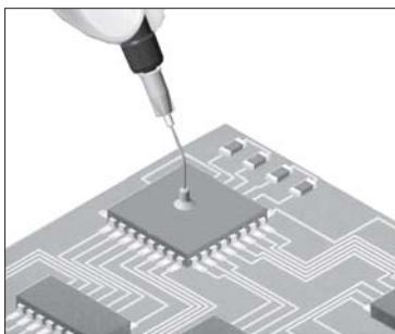
3 Una volta collocato il componente nella posizione corretta, saldare i piedini. Se si tratta di un circuito integrato tipo Flat Pack, saldare dapprima un piedino di ogni angolo del CI per fissarlo al circuito.
